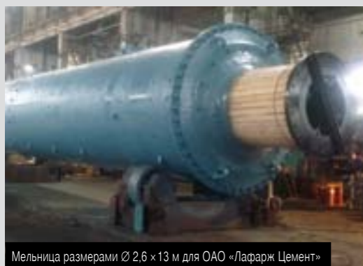
Мельница размерами Ø 2,6 × 13 м для ОАО «Лафарж Цемент»
